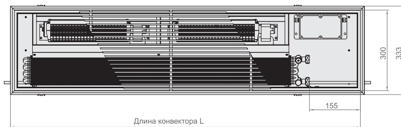
Вид сверху конвектора Qtherm НК2 310.150 с роликовой решеткой, с F-образным бортом.
