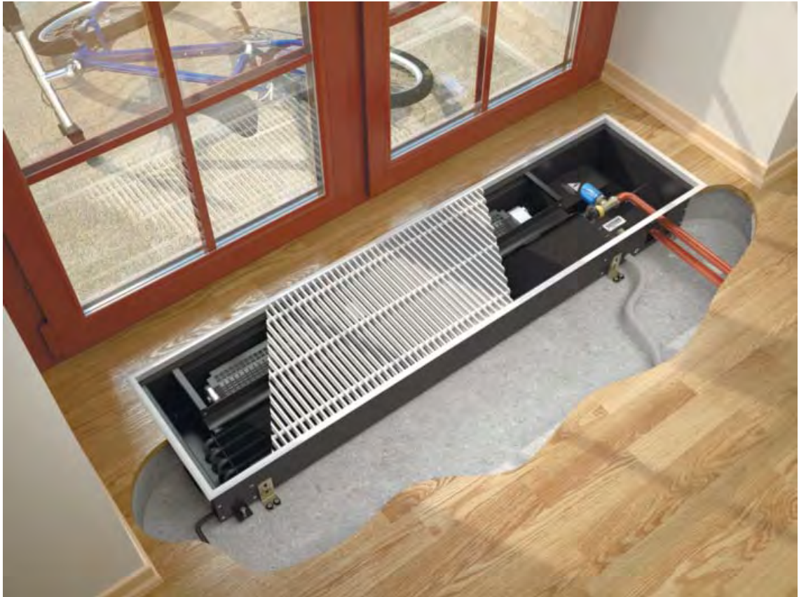
Монтаж конвектора Qtherm HK2 310.130 в двухтрубную систему с подключением "справа", расположение вентиляторов со стороны окна.
