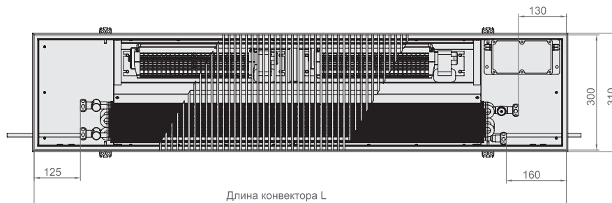
Вид сверху конвектора Qtherm НК4 310.130 с роликовой решеткой, с U-образным бортом.
