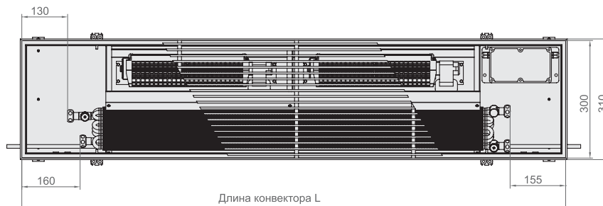
Вид сверху конвектора Qtherm НК4 310.130 с линейной решеткой, с U-образным бортом.
