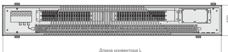
Вид сверху конвектора Qtherm Electro 190 с роликовой решеткой, с U-образным бортом.
