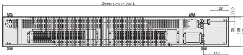
Вид сверху конвектора Qtherm ECO 175 с роликовой решеткой, с U-образным бортом.
